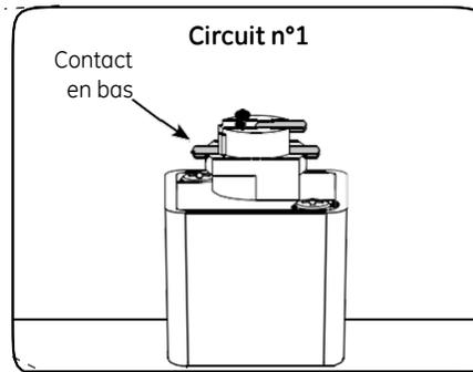
**Systèmes à un circuit :** aucun réglage nécessaire. Le contact est en position basse.
