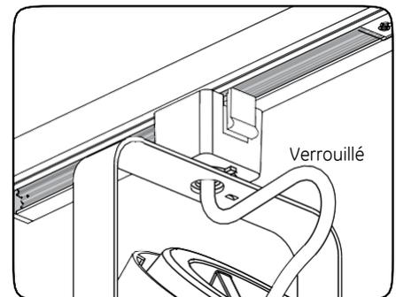
Relâchez la languette de verrouillage et le luminaire devrait s'enclencher en place.
