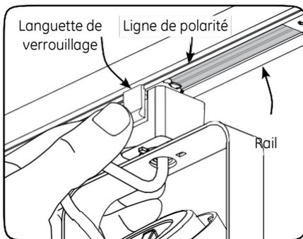
**1** Maintenez l'adaptateur sous le rail avec votre pouce sur la languette de verrouillage. Assurez-vous que la languette de verrouillage est positionnée directement sous la ligne de polarité. Poussez l'adaptateur dans le rail.
