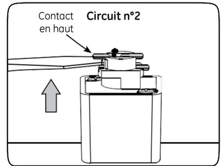
**Systèmes à deux circuits :** relevez le contact inférieur en position haute avec un petit tournevis plat.
