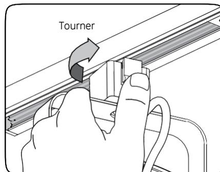
Tournez l'adaptateur à 90 degrés dans le sens horaire, en veillant à ce que les lignes de polarité du rail et de l'adaptateur de luminaire correspondent.
